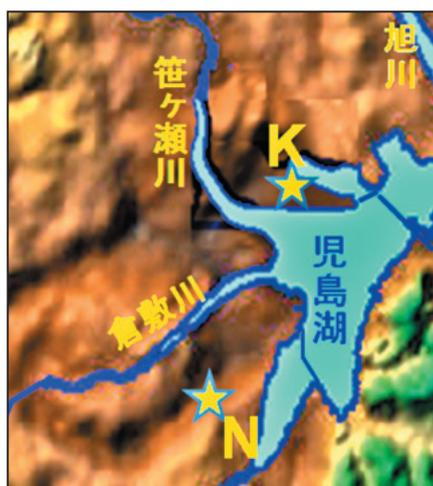
図1 児島湾干拓地中部における岡南飛行場(K)と七区小学校(N)の位置。背景は重力探査で推定した花こう岩質基盤上面の深さと凹凸<sup>2)</sup>。
