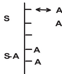
図11 金属面への潤滑油分子の吸脱着現象のメカニズム
